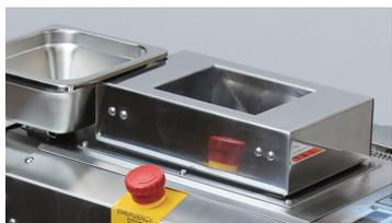
危険を感じて投入口を押すと、非常停止がかかる構造の安全装置を採用。生地がローラーに引っ張られて手指が投入口に触れても非常停止がかかります。
