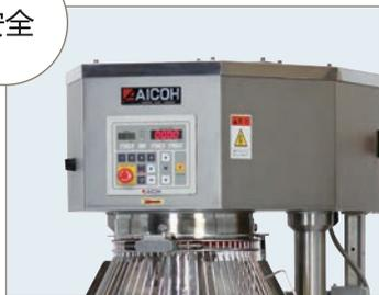
操作面板的侧面安装有确认开关。为了有效避免误操作造成的夹伤事故,只有在搅拌缸上升键和确认开关同时按下时,搅拌缸才会上升。
