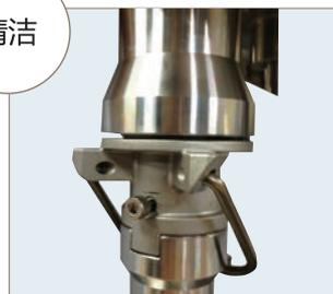
弹簧扣组件采用预留缝隙的设计,使清洗容易实施。
