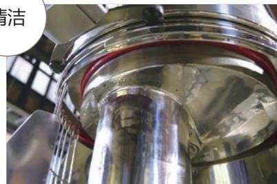
因采用高密封性密封圈,防止水份和粉料的混入。
