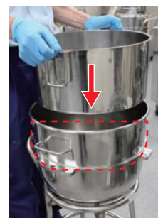
ビルトイン式 枠をボールにはめて使うタイプ
