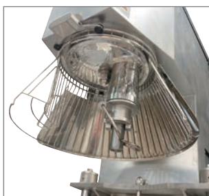
攪拌エリアはステンレス製
