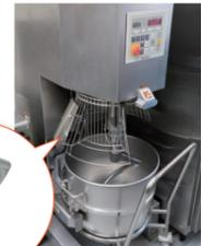
ミキサーはすぐに洗えるようシンク近くに配置。生地がミキサーボールにこびりついているのが嫌で仕込むたびに洗うのですが、この台車の使い勝手がとても良くて気に入っています。これのおかげで毎日の作業の腰への負担も軽減されました!ドラゴンフックも生地をかき落とさなくて済むので助かっています。
