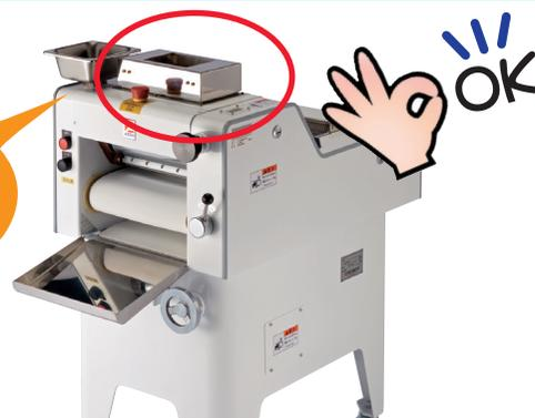
2008年以降に製造されたモルダーには急停止装置を内蔵した「安全ホッパー」が搭載されています。労働安全衛生規則の要求をはるかに上回るより高い安全性があるので、装着をお勧めいたします。
