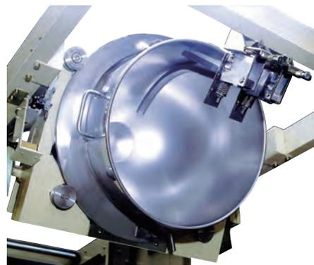
専用フランジ付ボール容器にのみ利用できます。スーパーツインミキサー60、スーパーツインミキサー90の専用ボールに対応できます。
