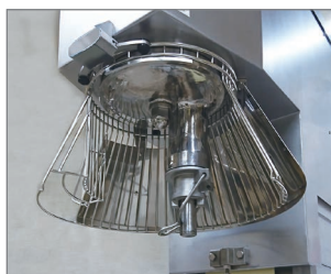
攪拌エリアはステンレス製
